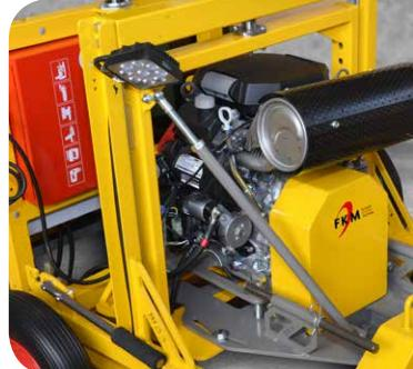
**FKM****RG2****WELLENSCHLEIFMASCHINE****Zum Reprofilieren des Schienenprofils**
